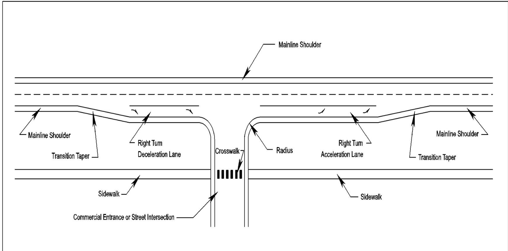
**FIGURE 3-32 TYPICAL APPLICATION OF A RIGHT TURN ACCELERATION AND DECELERATION LANE
